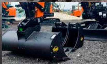
GODETS DE NIVELAGE / CURAGE
